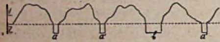
Fig. 4. Het verloop der amplitude van de gemoduleerde draaggolf van den televisiezender. Z = amplitude bij „zwartmodulatie”; L = amplitude, waarover de lichtmodulatie zich uitstrekt; a = onderbrekingen van de draaggolf aan het einde van elke beeldlijn; b = langere onderbreking aan het eind van elk volledig beeld.
